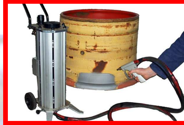
Verwijderen verf / roest van staal
